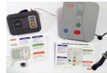
Links analoges, rechts digitales Hausnotrufgerät
